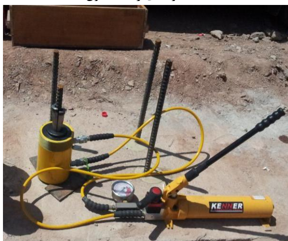
جک ۶۰ تن جهت تست میلگرد کاشته شده در بتن
