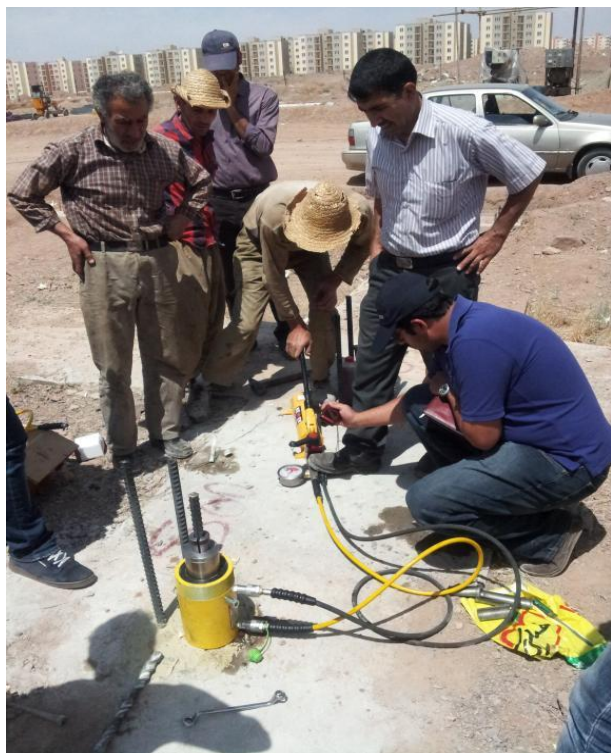
آزمایش کشش میلگرد کاشته شده در بتن
